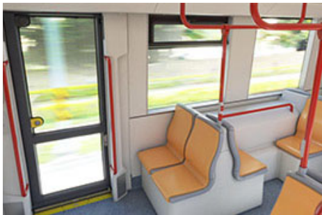
Se ha eliminado el escalón en el módulo central.
